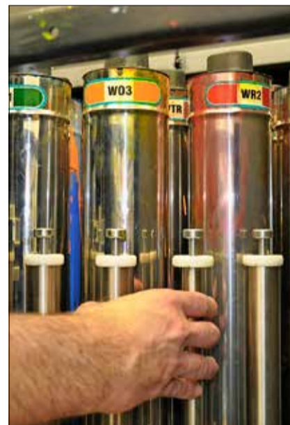
Die Farbbehälter im Innern sind in einer Revolvertrommel angeordnet.
